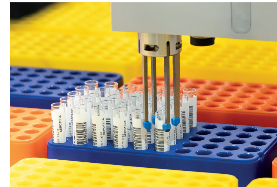
Sistema de preanàlisi per a la distribució, arxiu i aliquotació de les mostres.
